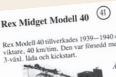
Rex Midget Modell 40 Rex Modell 40 tillverkades 1939-1940 och var viktare, 40 km/tim. Den var försedd med Willy 3-växl. låda och kickstart.
