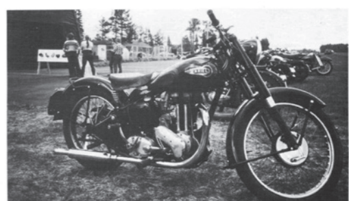
Thyra Nilssons NSU Super Max från 1957. 250 cc med överliggande kamaxel.
